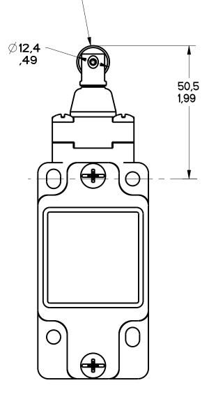
FIGURE 5 - TOP ROLLER PLUNGER HEAD OTHERWISE REFER TO FIGURE 1
